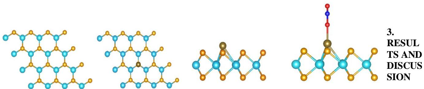
Figure 1 (a)  $\text{MoSe}_2$  (b)  $\text{Fe}-\text{MoSe}_2$  (Top View) (c)  $\text{Fe}-\text{MoSe}_2$  (Side View) (d)  $\text{CO}_2$  adsorbed  $\text{Fe}-\text{MoSe}_2$
